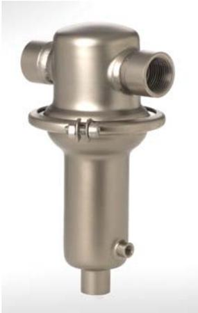
Перепускные клапаны регулируют настраиваемое постоянное давление. Пружина сжатия удерживает клапан закрытым. При увеличении входного давления клапан открывается и дает среде вытекать до тех пор, пока снова не будет достигнуто установленное заданное значение. Перепускные клапаны также называют редуцированными клапанами.
