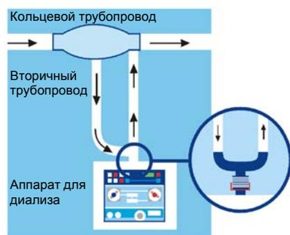
Система отбора без мертвых зон предназначена для снабжения аппаратов для диализа пермеатом из главного кольцевого трубопровода. При этом используется закон Бернулли, позволяющий вызвать циркуляцию в замкнутой системе, изменив статическое и динамическое давление. Это делается без подвода энергии извне. В сочетании с Y-образным соединительным элементом эта система отбора гарантирует снабжение аппарата для диализа пермеатом без мертвых зон.
