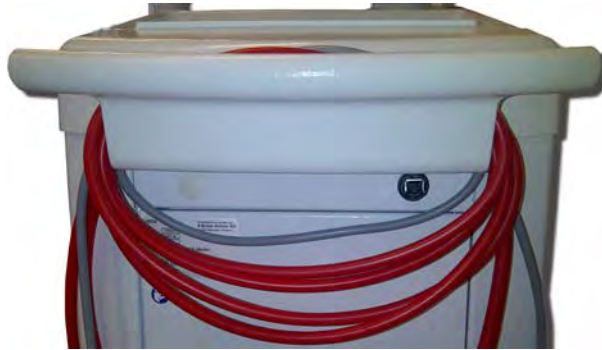
Bild 4-1 Förvaring av kablar och slangar
