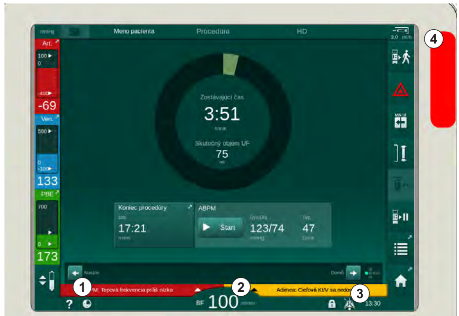
Zobr. 12-1 Pole alarmov a varovaní a signalizačné svetlo
