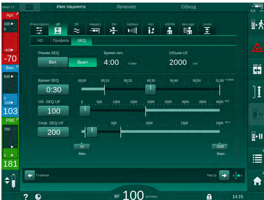
Рис. 6-6 Последовательная (изолированная) ультрафильтрация
