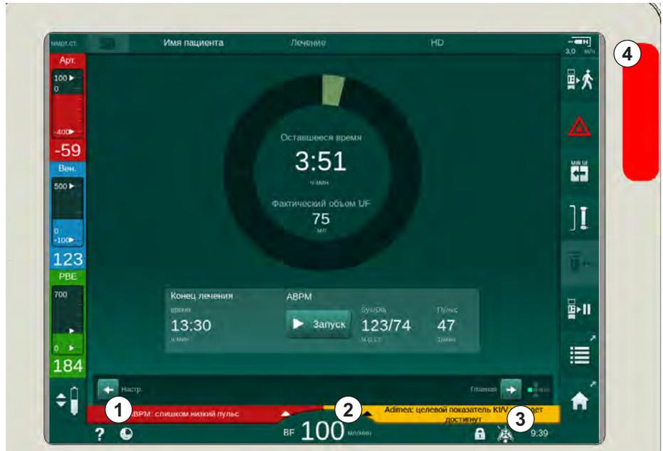
Рис. 12-1 Поля сигналов тревоги и предупреждений и сигнальная лампа
