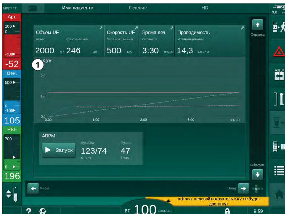
Рис. 6-12 График Kt/V на *Главном* экране
