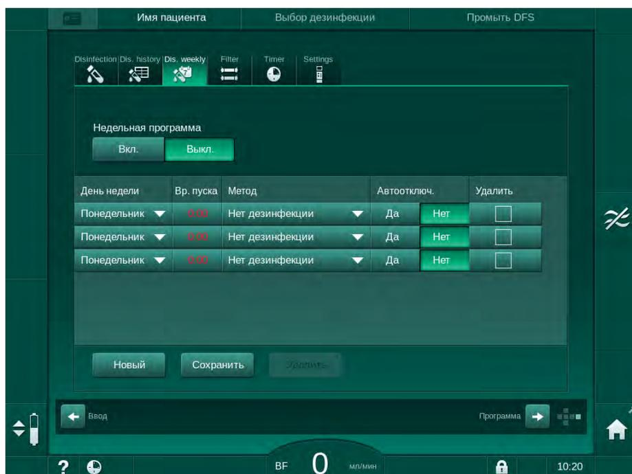
Рис. 7-17 Программа еженедельной дезинфекции на экране *Настройка*
