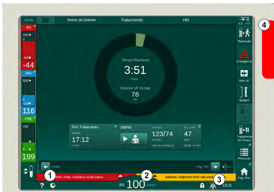
Fig. 3-13 Campos de alarme e avisos
