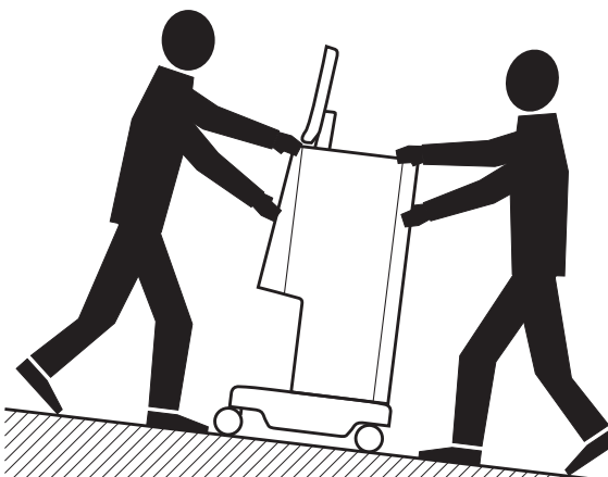
Fig. 4-2 Transporte do equipamento de diálise em escadas e declives (2 pessoas)
