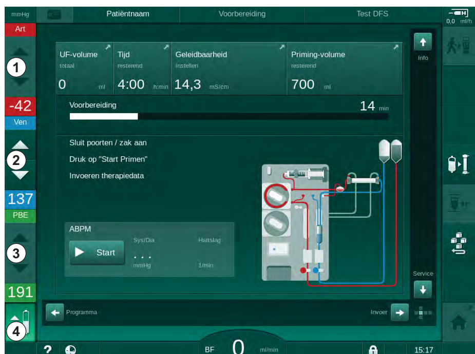
Afb. 5-10 Niveauregeling in voorbereiding
