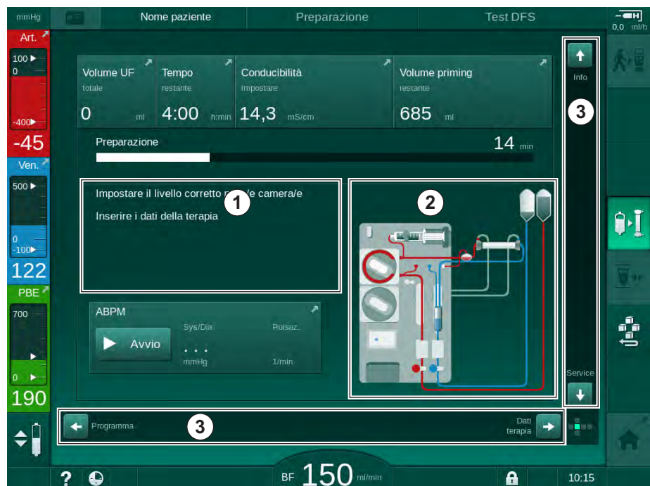
Fig. 3-12 Aree di istruzioni e barre di scorrimento della videata Home durante la preparazione
