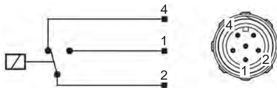
Fig. 11-42 Connettore chiamata infermiere
