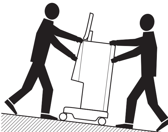
Fig. 4-2 Transport de l'appareil dans les escaliers et dans les zones en pente (2 personnes)
