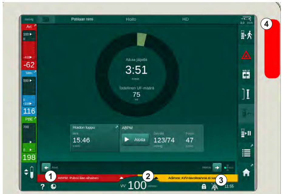
Kuva. 12-1 Hälytys- ja varoituskentät ja merkkivalo
