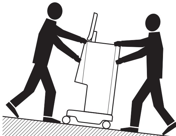
Joon. 4-2 Masina liigutamine treppidel ja kallakutel (2 inimest)
