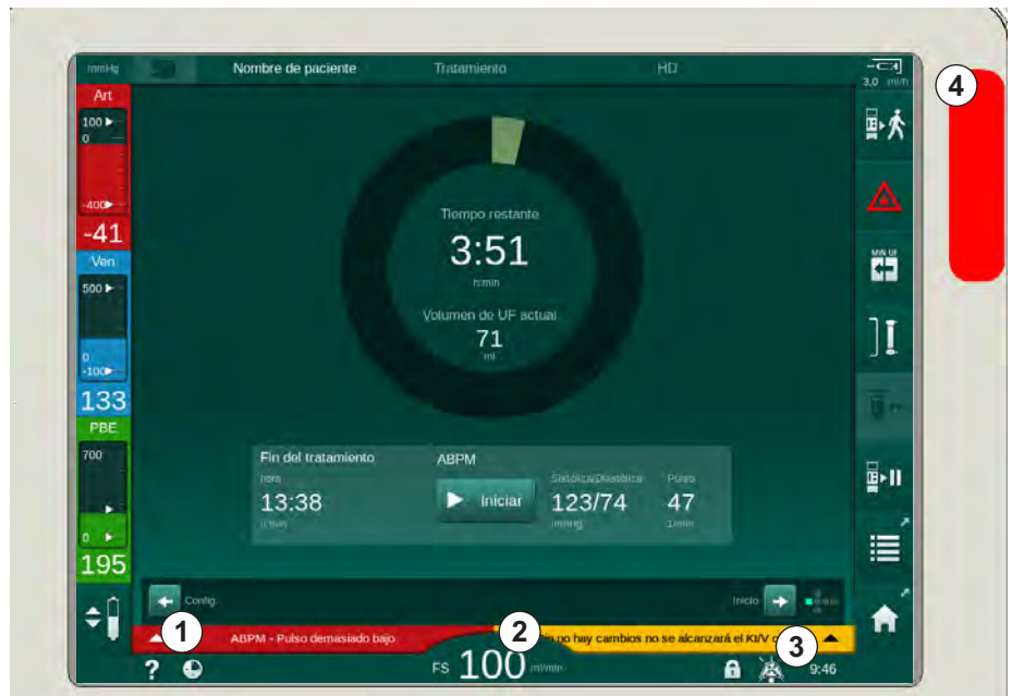
Fig. 12-1 Campos de alarmas y advertencias e indicador luminoso
