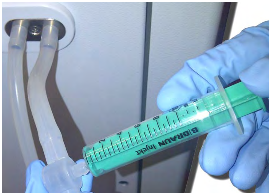
Fig. 5-25 Puerto de toma de muestras
