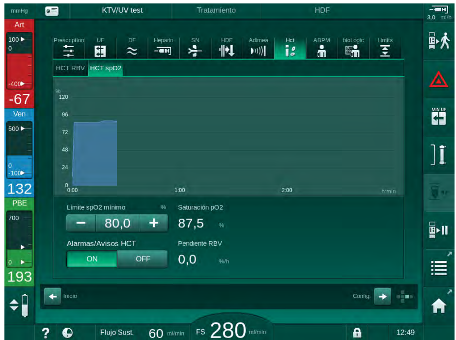
Fig. 11-16 Saturación de O 2 en la pantalla Entrada
