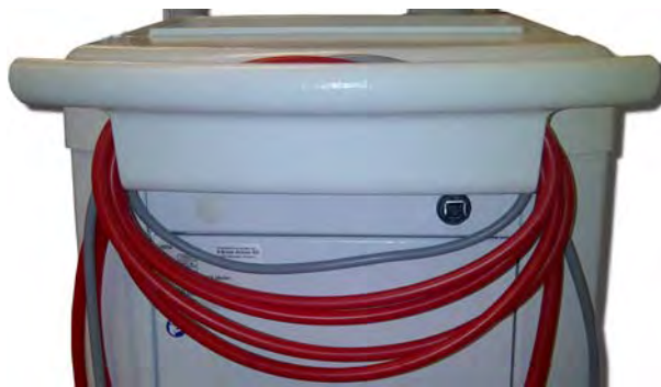
Εικ. 4-1 Αποθήκευση καλωδίων και σωλήνων
