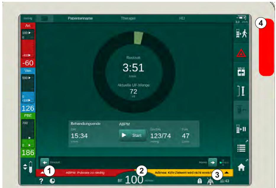
Abb. 12-1 Alarm- und Warnfelder und Signalleuchte
