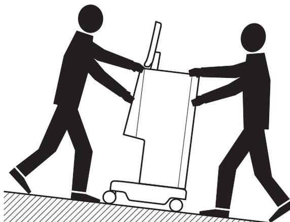
Abb. 4-2 Transport des Geräts über Stufen und Schrägen (2 Personen)
