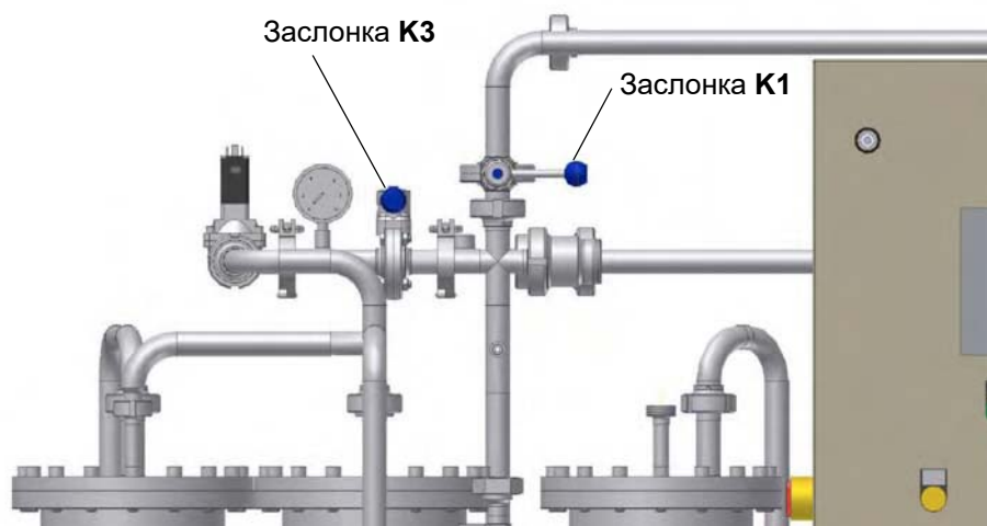
Рис. 18-3: Клапанные заслонки для аварийного режима К1/К3 (здесь в нормальном положении: К1 и К3 закрыты)
