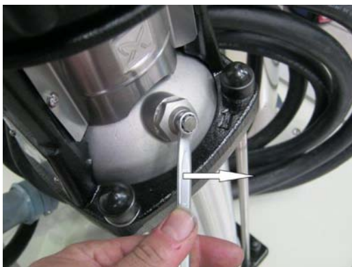
Рис. 4-1: Открывание резьбовой пробки для выпуска воздуха
