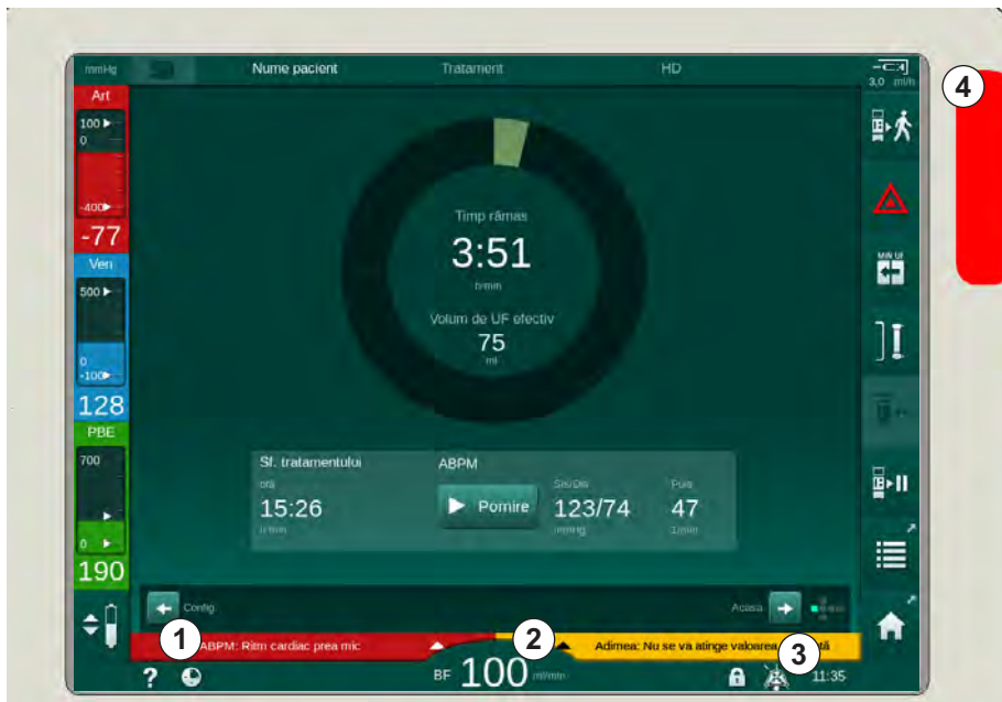
Imaginea 12-1 Câmpuri pentru alarme și mesaje și lampă de semnalizare
