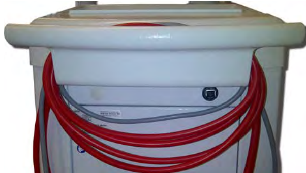
Imaginea 4-1 Depozitarea cablurilor și a tuburilor
