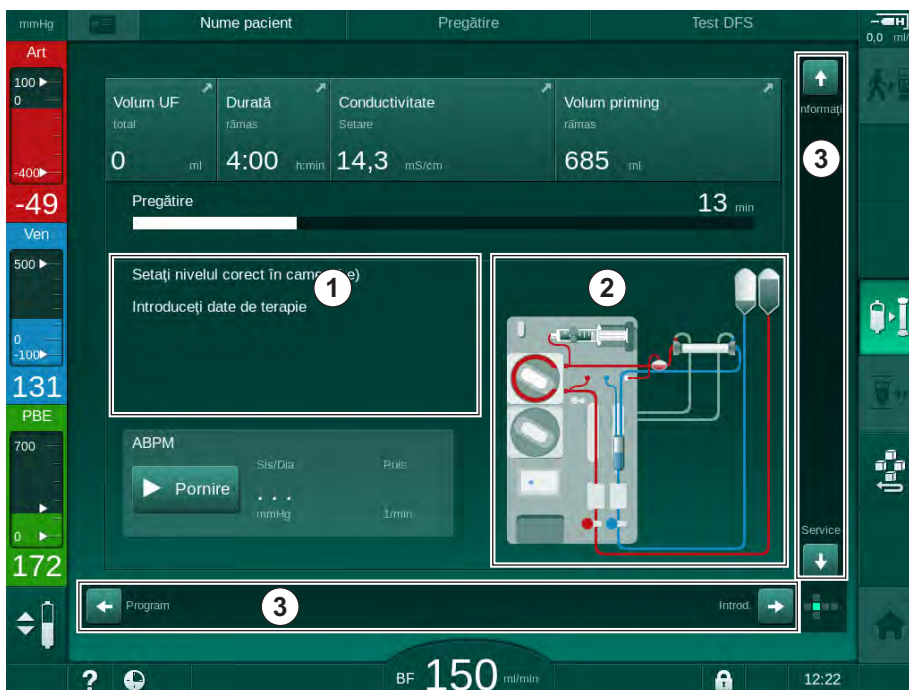
Imaginea 3-12 Zone cu instrucțiuni și bare de derulare în ecranul Ecran principal în modul pregătire
