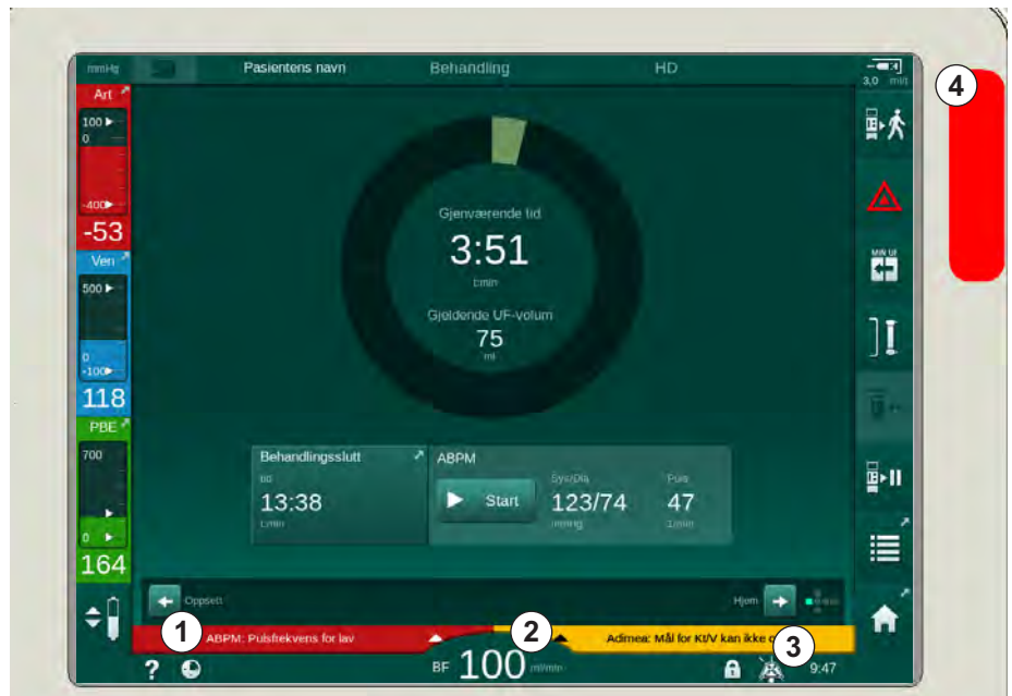
Fig. 12-1 Alarm- og advarselsfelt og signallampe
