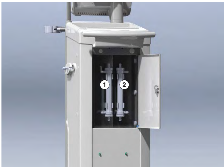
Fig. 7-4 Filterhus med deksel på baksiden av maskinen
