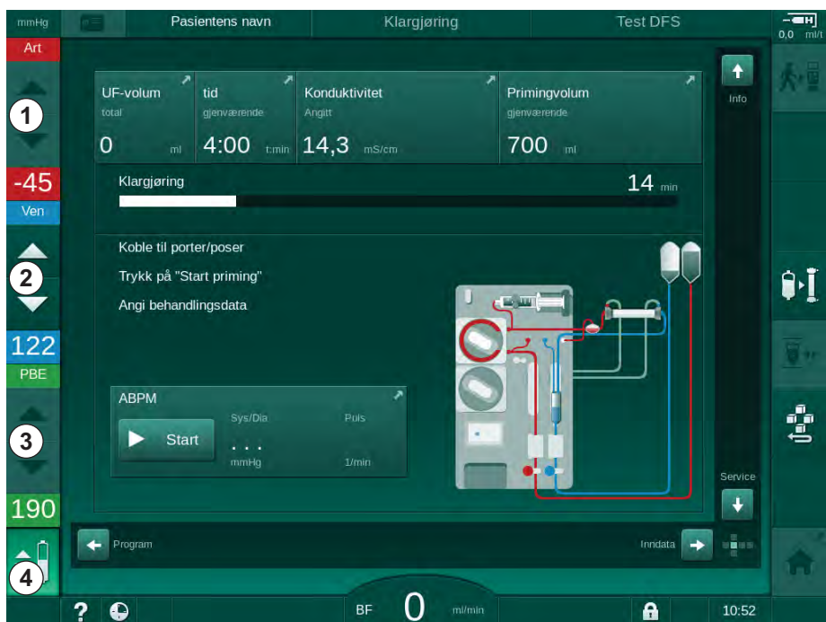
Fig. 5-10 Nivåregulering under klargjøring
